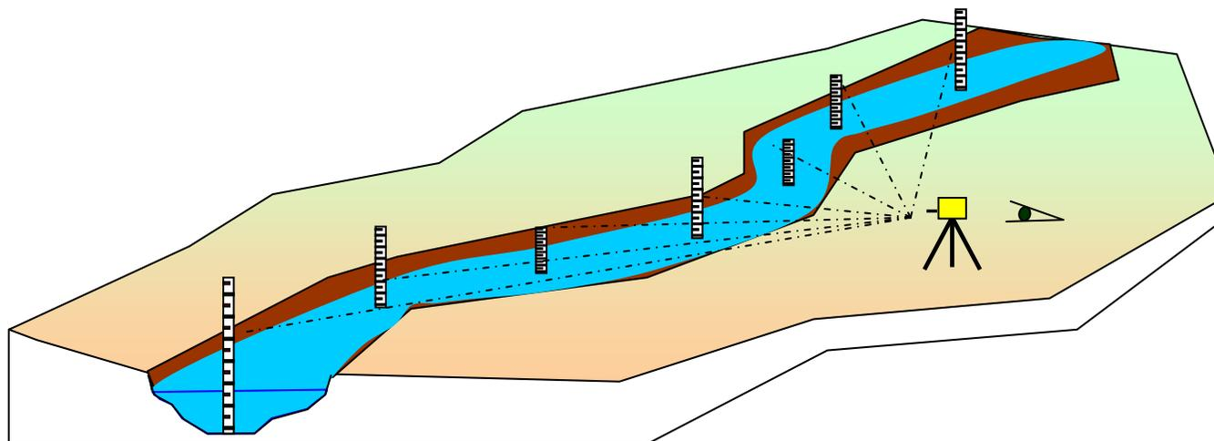
L'établissement du profil en long s'effectue à partir des mesures du point le plus bas de la section en travers du lit mouillé.
