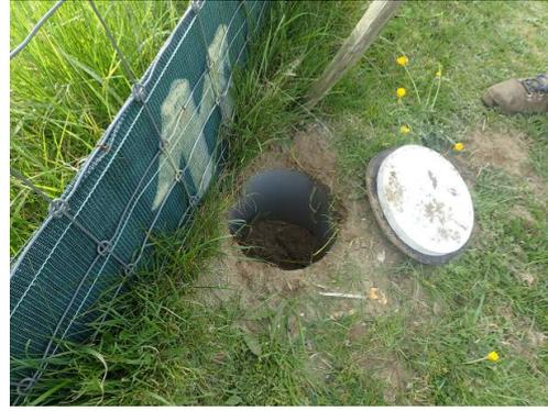
*Photo 18 : Exemple d'amélioration d'un seau avec l'existence d'une section de tube PVC ouvert directement sur le sol nu et muni d'un couvercle lorsque il s'agit d'interrompre la capture sur la RD 940 - (dunes de Slack)
