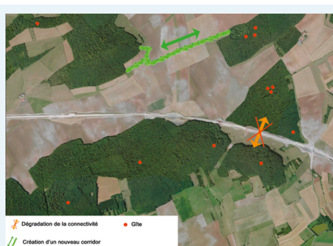
Illustration 92 : Principe de création d'un corridor permettant de compenser la coupure en rendant accessibles de nouvelles zones favorables (Source : Cerema - Est sur Othophotoplan IGN)
