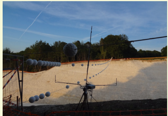
Photo 35 : Dispositif de guidage installé au droit de la coupure forestière (Source : Hipollyte Pouchelle/Egis)
