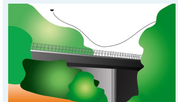
Exemple schématique d'une configuration défavorable aux chiroptères lorsque la cime des arbres se situe à la hauteur du tablier du viaduc (Source : Cerema - Est)
