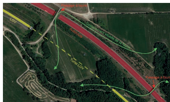
16 Infrastructures jumelées où les passages à faune de l'infrastructure routière sont situés dans le prolongement du tunnel ferroviaire. Source : Google Earth.
